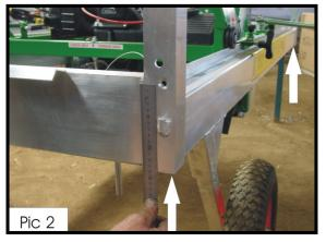
STEEL TROLLEY MEASUREMENT FOR CHAIN HEAD PIN HOLE IS 35MM DOWN FROM TROLLEY ROLLER HOLE – (see diagram on next page)
